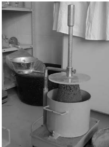
Rys. 3. Badanie konsystencji metodą Ve-Be [fot. B. Kalinowski]
