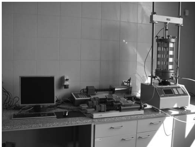
Rys. 6. Aparat trójosiowego ściskania do badań próbek gruntów z kontrolowanym stanem nasycenia – Pracownia Monitorowania Przepływu Wód Podziemnych
