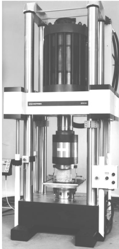
Rys. 7. Uniwersalna maszyna wytrzymałościowa do realizacji obciążeń statycznych i pulsacyjnych – 2500 kN (Katedra Budownictwa i Geodezji – Pracownia Wytrzymałości Materiałów i Konstrukcji Budowlanych)
