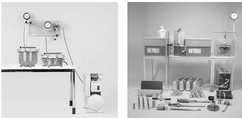
Rys. 5. Urządzenia do pomiaru właściwości retencyjnych ośrodków porowatych – Eijkelkamp (Katedra Kształtowania Środowiska – Pracownia Fizyki Ośrodków Porowatych)
