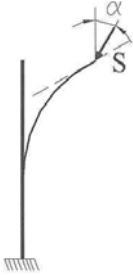
Rys. 1. Oddziaływanie niekonserwatywnej siły osiowej Fig. 1. Effect of non-conservative axial force
