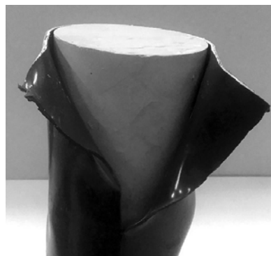
Rys. 7. Usuwanie formy negatywowej poprzez nagrzewanie opalarką i stopniowe rozrywanie formy Fig. 7. Removing the negative form by heating with a heat gun and gradually tearing the form
