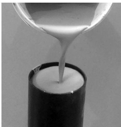
Rys. 6. Zalewanie formy negatywowej Fig. 6. Negative form flooding
