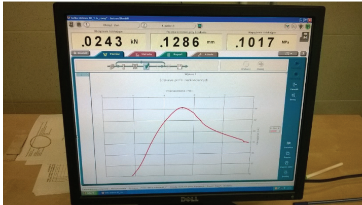
Rys. 6. Widok monitora prezentującego wykres obciążeń badanego elementu zachodzących podczas prób
