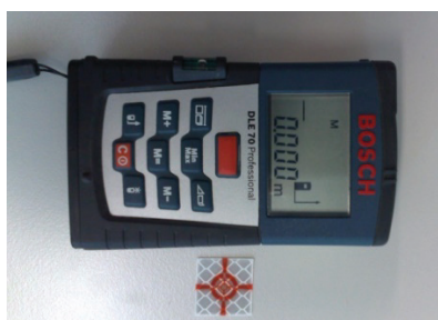
Rys. 4. Widok przykładowego ręcznego dalmierza laserowego Bosch DLE 70
