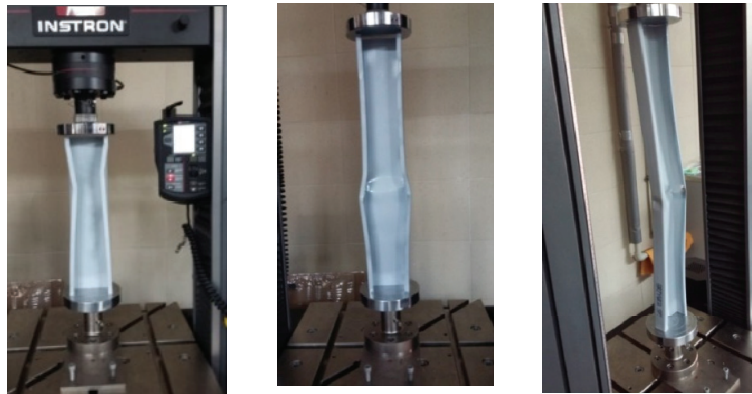
Rys. 8. Widok badanych kształtowników po wykonaniu testów wytrzymałościowych Fig. 8. View of the examined elements after strength tests
