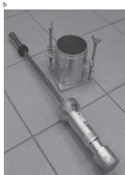
Rys. 2. Ubijaki Proctora: a – mechaniczny według PN-88/B-04481:1988, b – ręczny według PN-EN 13286-2:2010 (ubijak A + cylinder A)
