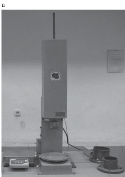
Rys. 2. Ubijaki Proctora: a – mechaniczny według PN-88/B-04481:1988, b – ręczny według PN-EN 13286-2:2010 (ubijak A + cylinder A)
