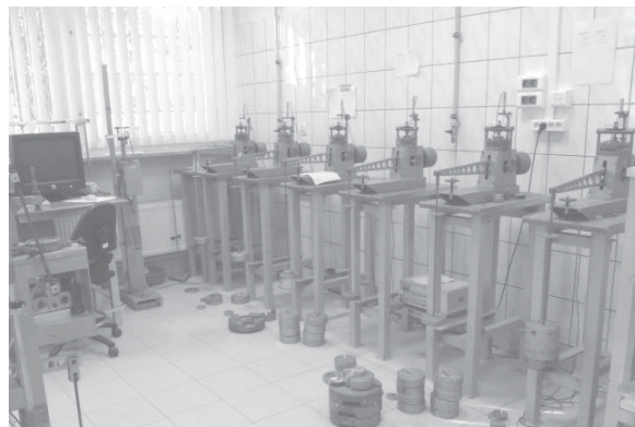
Rys. 3. Stanowisko badawcze z edometrami Fig. 3. Laboratory test post with the oedometer apparatus
