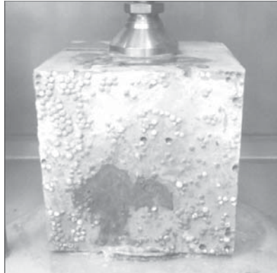
Rys. 4. Przecieki wody podczas badania wodoszczelności
