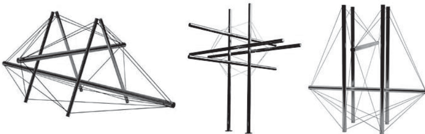
Rys. 11. Konstrukcje typu tensegrity możliwe do wykorzystania w mostownictwie [Skelton i de Oliveira 2009]
