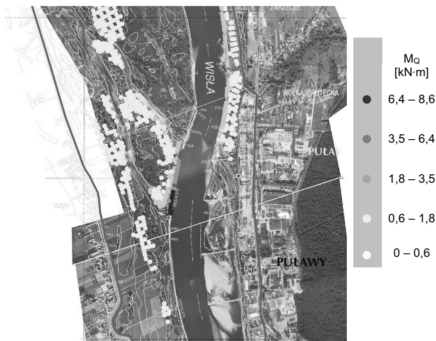
Rys. 6. Rozkład wartości krytycznych momentów na skutek działania parcia dynamicznego wody w badanym obszarze
