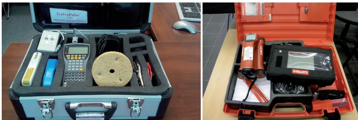
Rys. 2. Wykorzystane urządzenia pomiarowe: a – zestaw GP-5000 GalvaPulse™; b – skaner PS 200s Hilti
