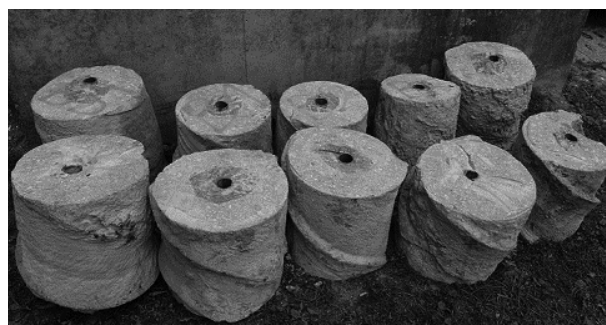
Rys. 1. Pale po wydobyciu z gruntu oraz wyodrębnione odcinki do badań betonu
