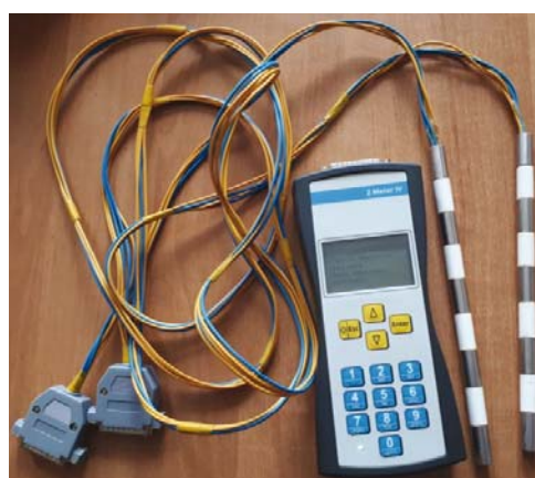
Rys. 3. Widok aparatu Z-Meter IV oraz elektrod pomiarowych EIS (fot. A. Gruchot)
