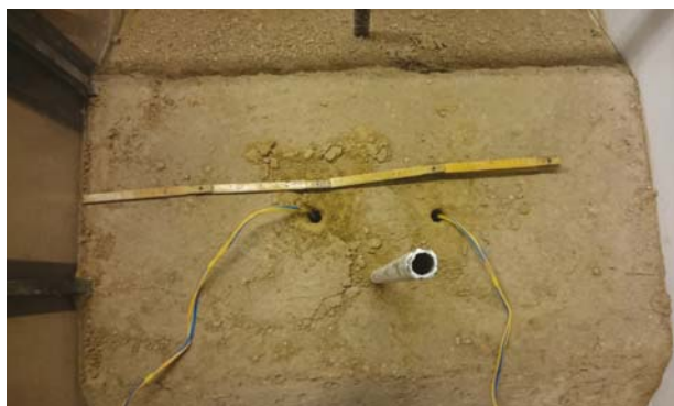
Rys. 4. Widok korony modelu obwałowania w trakcie instalowania elektrod pomiarowych EIS (fot. A. Gruchot)
