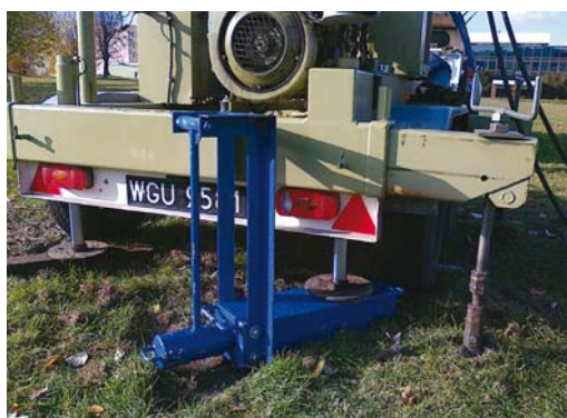
Rys. 3. Przyrządy wykorzystane do wzbudzenia fali poprzecznej: a – drewniana belka, b – stalowa belka (Galas, 2013)
