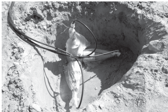
Rys. 4. Czujniki jednoosiowe typu 8340 firmy Brüel & Kjær przykręcone do aluminiowej głowicy i zakopane w gruncie (sposób nr 6) Fig. 4. The uniaxial Brüel & Kjær sensors type 8340 bolted to the aluminum head and buried in ground (method No. 6)
