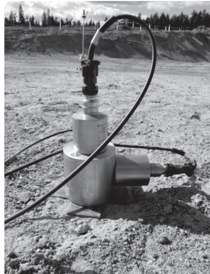
Rys. 3. Czteropunktowo kotwiona podstawa krzyżakowa (sposób nr 5) z czujnikami typu 8340 firmy Brüel & Kjær Fig. 3. The four-point anchored cross-base (method No. 5) with mounted Brüel & Kjær sensors type 8340
