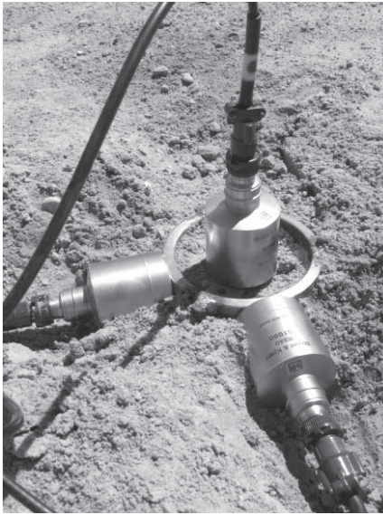
Rys. 2. Trójpunktowo kotwiona podstawa pierścieniowa (sposób nr 4) z czujnikami typu 8340 firmy Brüel & Kjær Fig. 2. The three-point anchored base ring (method No. 4) with mounted Brüel & Kjær sensors type 8340
