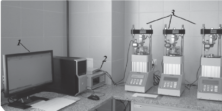
Rys. 3. Stanowisko do edometrycznych badań laboratoryjnych ACONS: 1 – system rejestracji z programem ClispStudio, 2 – miniscanner, 3 – trzy niezależnie pracujące automatyczne edometry
