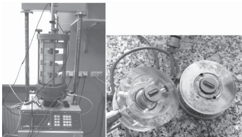
Rys. 3. Stanowisko badawcze z aparatem trójosiowego ściskania oraz przetworniki rodzaju bender (fot. autorów)
