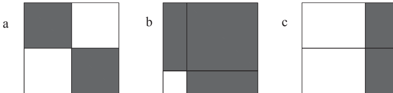
Rys. 4. Przykłady rozkładu materiałów w komórce: a – przewodnik typu szachownica, b – przewodnik zbrojony, c – laminat Fig. 4. Examples of material distribution in a cell: a – chess-type conductor, b – reinforced conductor, c – laminate
