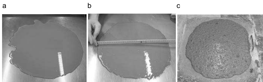
Fot. 2. Wyniki rozptywu zaczynu (a) – średnica 51 cm, i zaprawy (b) – średnica 33,5, z użyciem stożka Hagermanna dla mieszanki wykonanej według zaleceń metody chińskiej, oraz właściwej mieszanki (c) – nieregularny rozptyw zaczynu jest efektem użycia mniejszej ilości spoiw niż w innych metodach
