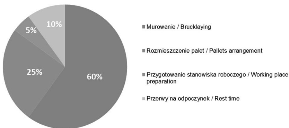
Rys. 2. Procentowy udział czasu trwania poszczególnych operacji w robotach murarskich Fig. 2. Percentage share of duration of individual operations in bricklaying works
