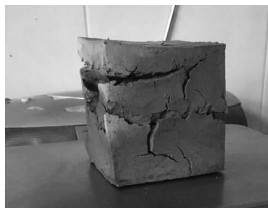
Rys. 1. Silne pęknięcia próbki w wyniku skurczu suszenia Fig. 1. Strong cracks of the sample as a result of contraction of the drying
