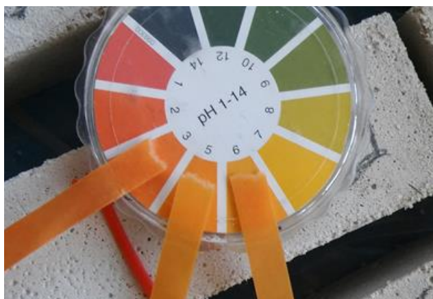
Rys. 2. Przyrównanie papierków lakmusowych ze skalą porównawczą pH
