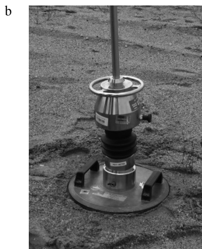
Rys. 2. Aparatura badawcza: a – układ pomiarowy typu LAN-XI firmy Brüel&Kjær, b – lekka płyta dynamiczna typu ZFG-01
