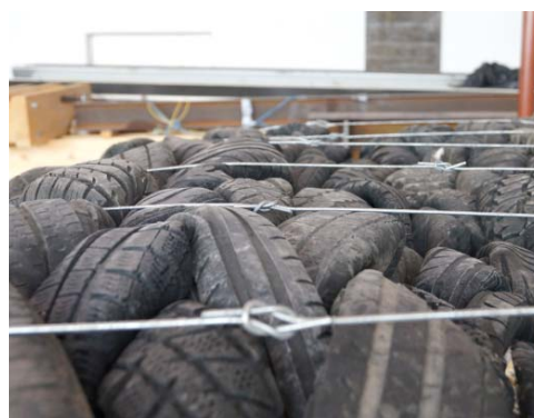
Rys. 1. Pakiety SZOS (u góry), połączenie drutów spinających pakiety (na dole)
