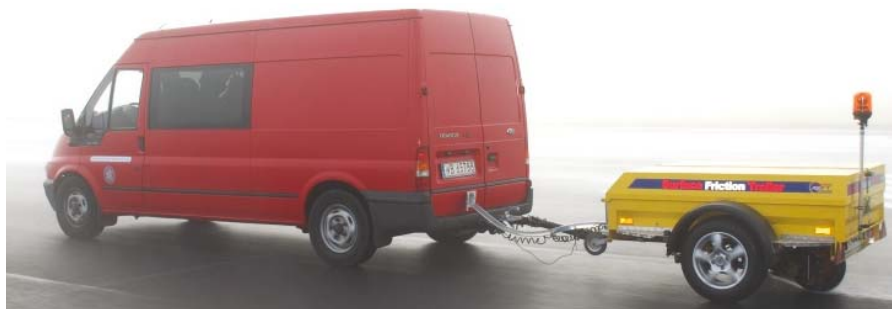
Rys. 3. Wykonywanie pomiarów współczynnika tarcia nawierzchni elementu funkcjonalnego lotniska z wykorzystaniem przyczepowego testera tarcia T-10 firmy ASFT (ITWL, 2014)
