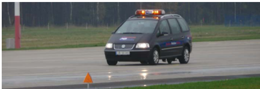
Rys. 2. Pomiar współczynnika tarcia nawierzchni elementu funkcjonalnego lotniska za pomocą testera tarcia firmy ASFT zbudowanego na samochodzie VW Sharan (ITWL, 2014)
