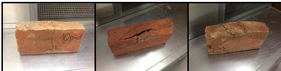
Rys. 3. Próbkki 10p-1, 8p1 i 3p-1 po badaniu mrozoodporności (fot. D. Zakrzewski, 2016)
