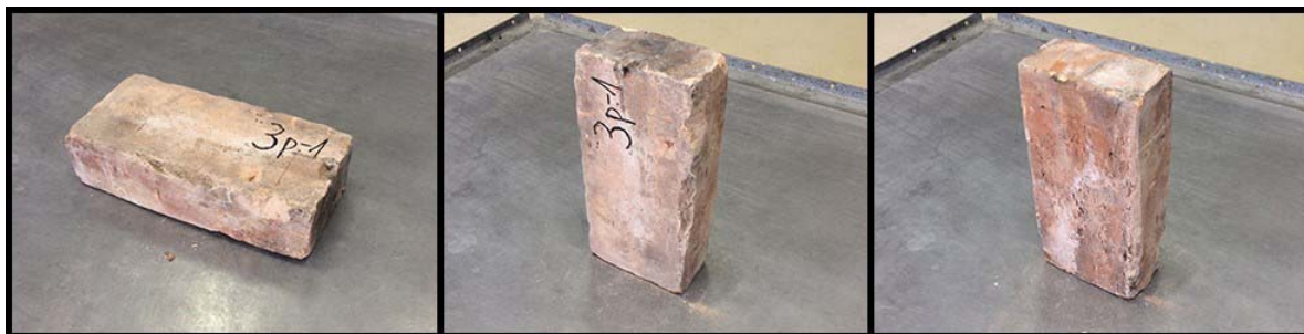
Rys. 2. Przykładowa cegła z piwnicy poddana badaniom (fot. D. Zakrzewski, 2016)
