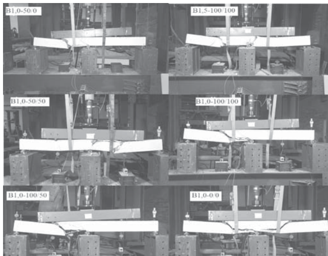
Rys. 4. Model zniszczenia belek dwuprzęsłowych serii B
