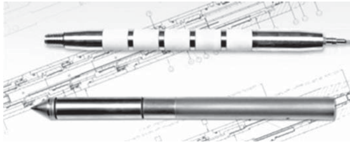
Rys. 7. Stożki do badań środowiskowych – conductivitycone (góra), envirocone (dół) – ap van den Berg
