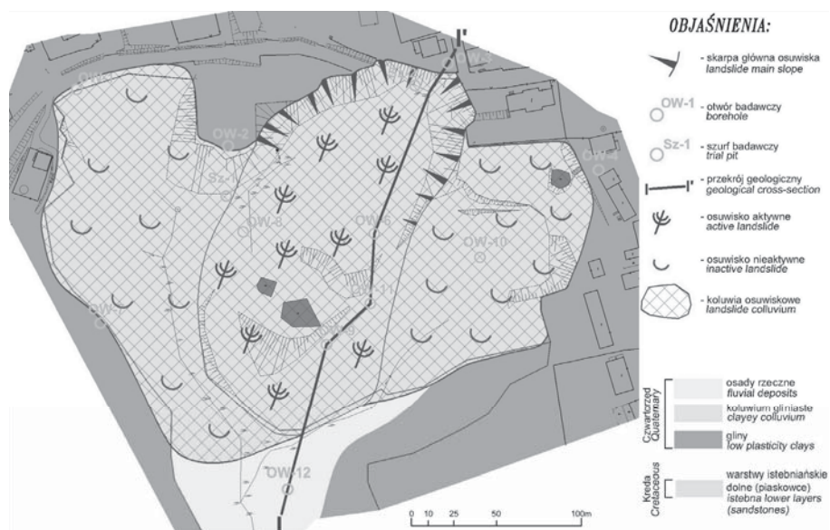
Rys. 2. Mapa warunków geotechnicznych w rejonie analizowanego osuwiska
