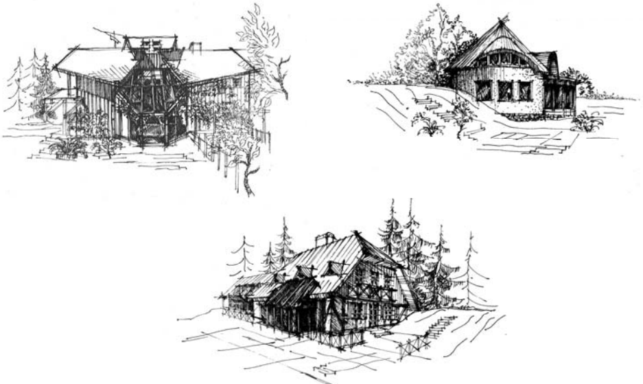
Rys. 2. Przykładowe możliwości wkomponowania przeszklenia cieplarni w bryłę budynku (rys. autor)
