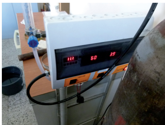
Rys. 4. Komora do badań przyspieszonej karbonatyzacji Fig. 4. Chamber to research accelerated carbonation test
