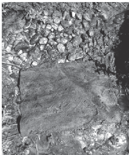
Rys. 1. Geowłóknina po 22 latach eksploatacji
