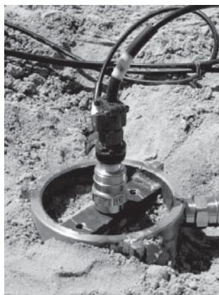
Rys. 3. Podstawa pierścieniowa z czujnikami przyspieszeń
